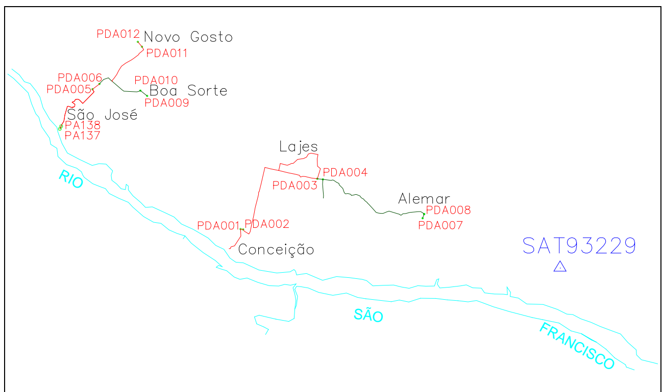
Figura 2 – Esquema da Densificação do Apoio Planialtimétrico
